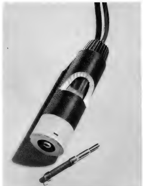
Bild 3. Das gebrauchsfertige Instrument, vorn der einsteckbare Tastwiderstand
